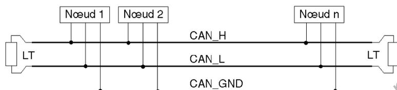
Chaque composant Schneider Electric CANopen permet une interconnexion des signaux suivants :
