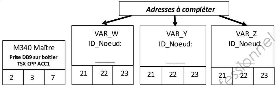
Schéma de connexion du bus CANopen
