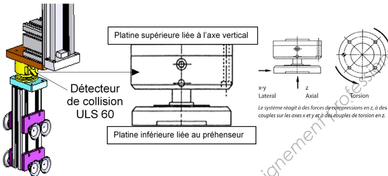
Les platines côté axe vertical et côté préhenseur sont maintenues pneumatiquement en position et forment dans des conditions d'utilisation normales une unité rigide.
