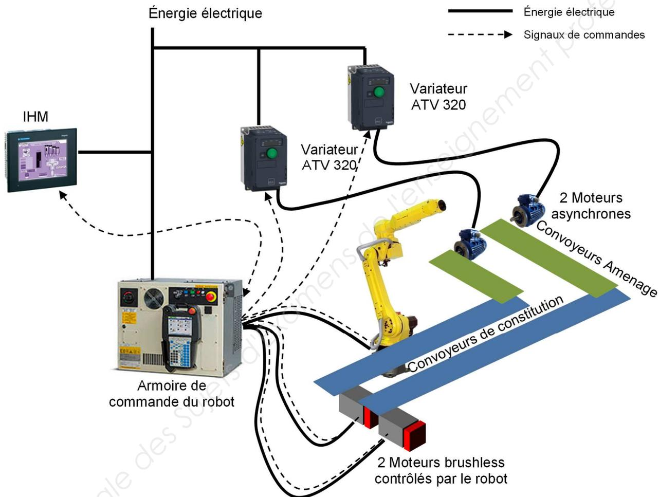
Dans cette architecture, la gestion des modes de marche et d'arrêt, le contrôle des trajectoires du robot, le positionnement des pâtons sur les convoyeurs de constitution ainsi que la vitesse des convoyeurs d'amenage sont réalisés par l'armoire de commande du robot.
