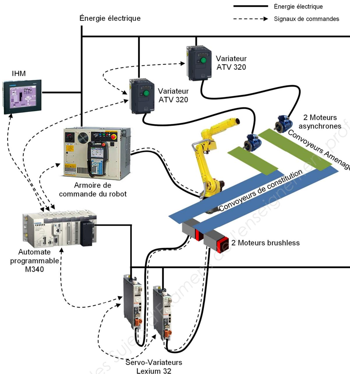
Dans cette architecture, la gestion des modes de marche et d'arrêt, le positionnement des pâtons sur les convoyeurs de constitution ainsi que la vitesse des convoyeurs d'aménage sont réalisés par un automate programmable. L'armoire de commande du robot ne réalise que le contrôle des trajectoires du robot.
