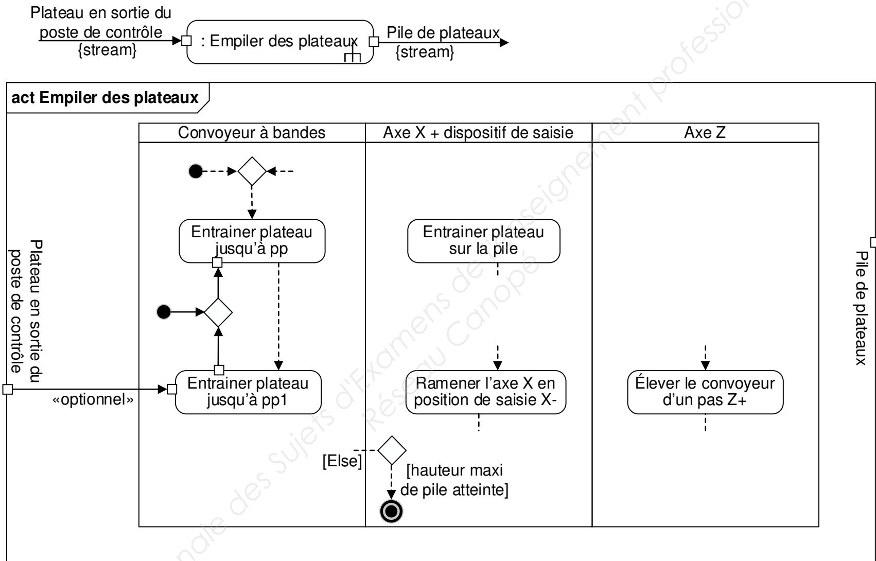
Lors du démarrage de l'activité « Empiler des plateaux », un plateau se trouve en position pp1 sur le convoyeur à bandes et le dispositif de préhension / axe X est en position de saisie. L'activité se termine après retour de l'axe X en position de saisie.
