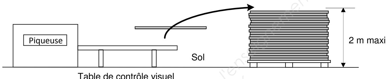
Le plateau est transféré par une combinaison de mouvements de la table de contrôle au sommet de la pile posée sur une palette qui reste immobile au sol. La hauteur maxi de l'ensemble palette + pile est de 2 m.
